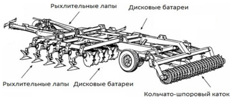
Рис. 1. Комбинированный почвообрабатывающий посевной агрегат АКК-6: схема расположения рабочих органов
