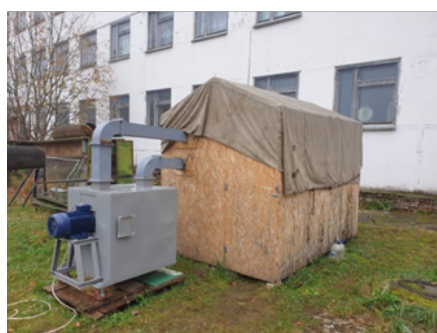
Рис. 2. Установка аэродинамического нагрева с макетом помещения:
