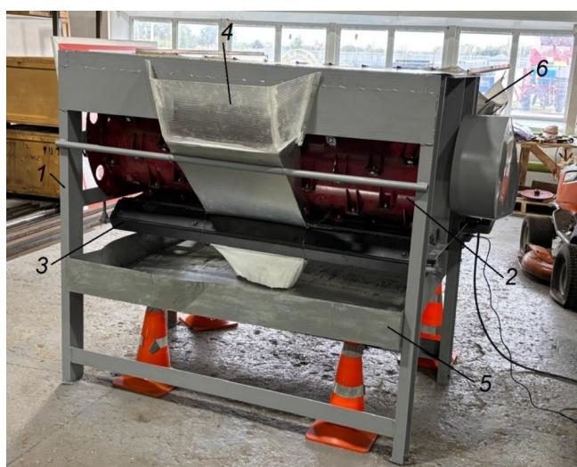
Рис. 2. Общий вид экспериментальной установки: 1 – рама; 2 – барабан-ускоритель; 3 – подбарабанье; 4 – устройство загрузочное; 5, 6 – емкости для сбора прохода и схода соответственно
