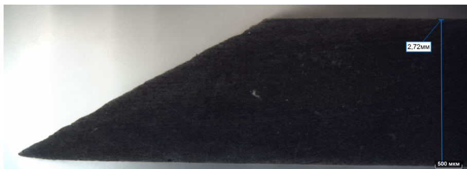
Рис. 6. Макроструктура ножей с углом заточки 30° после закалки и низкого отпуска, \times 16 Fig. 6. Macrostructure of blades with a 30° sharpening angle after quenching and low tempering, \times 16
