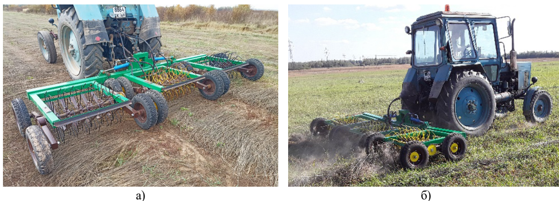
Рис. 9. Высокопроизводительный вспушиватель лент льна: общий вид (а); в работе (б) Fig. 9. High-performance flax stem strip fluffer: general appearance (a); in operation (b)
