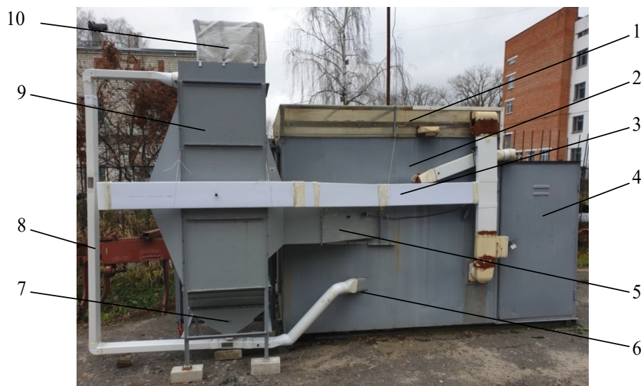
Рис. 4. Сушилка с материалопроводом пневмотранспортера прямоугольного сечения 120 \times 60 мм:
