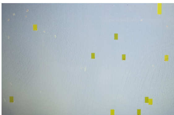
Рис. 4. Фотоснимок семян RGB камерой на инфракрасном фоне при инфракрасном освещении, совмещенном с белым светом, вариант В
