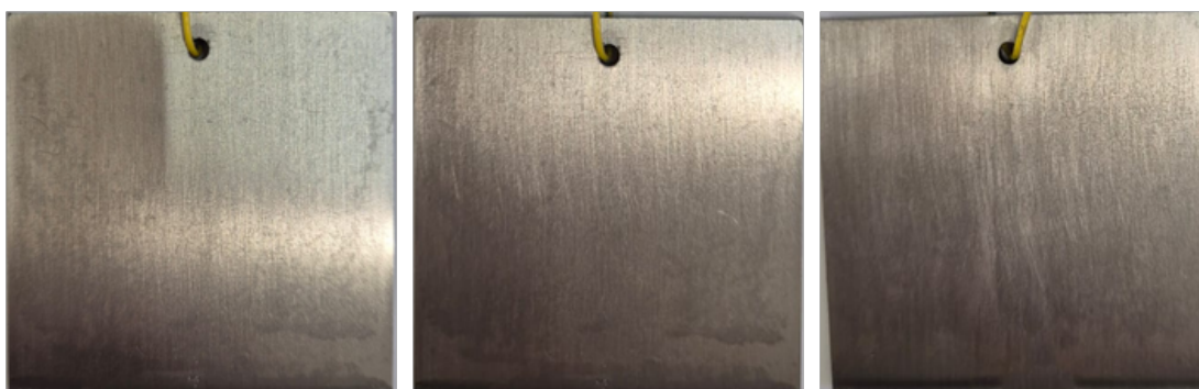
Рис. 1. Опытный образец после коррозионного испытания (без удаления продуктов коррозии)
