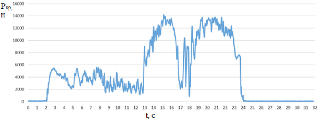
Рис. 3. Осциллограмма тяговой нагрузки при испытаниях на бетонном основании Fig. 3. Oscillogram of traction load during tests on a concrete base
