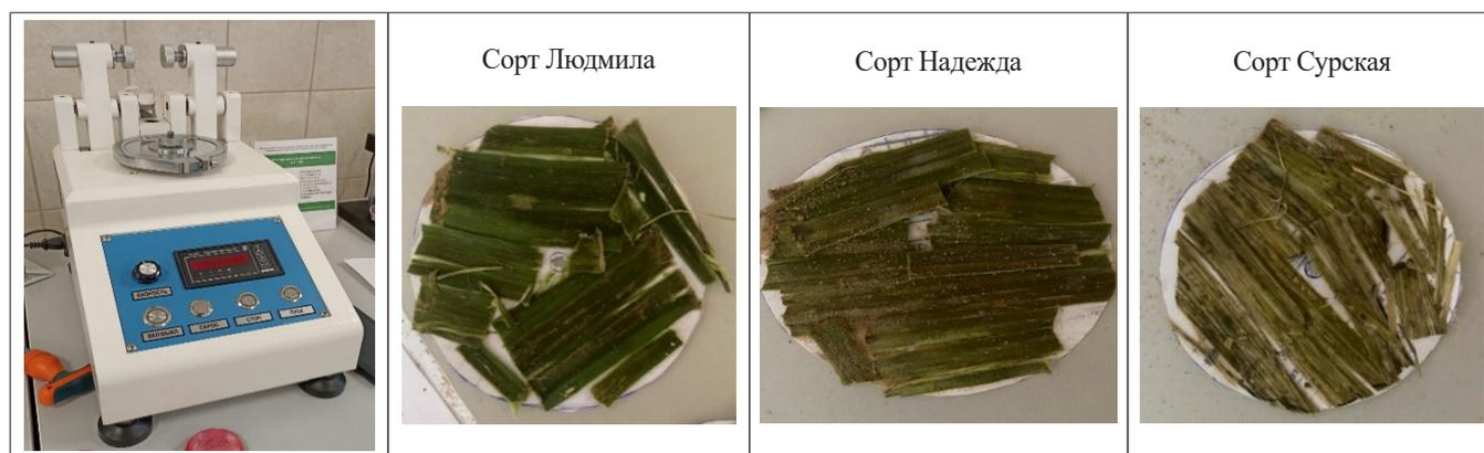
Рис. 1. Общий вид абразиметра АТ-100 и образцы технической конопли
