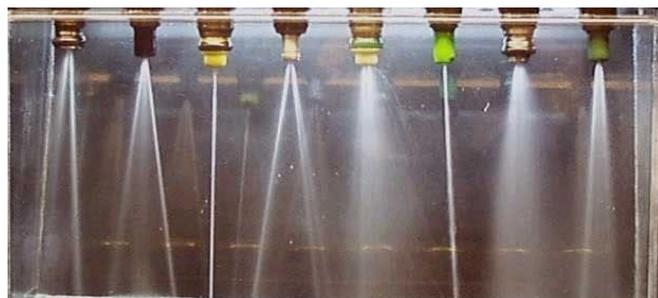
**Рис. 3. Изменение формы распыла в результате износа сопла**
