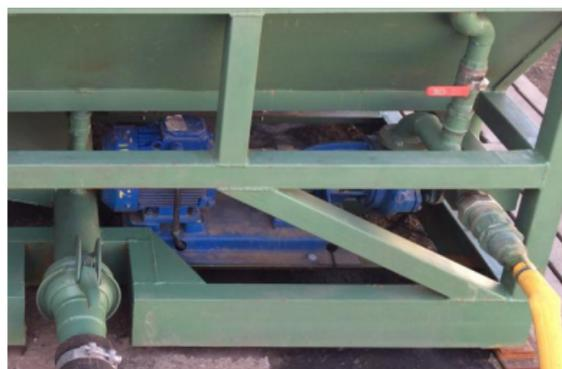
**Рис. 4. Погружной насос и подключение подачи и слива**
