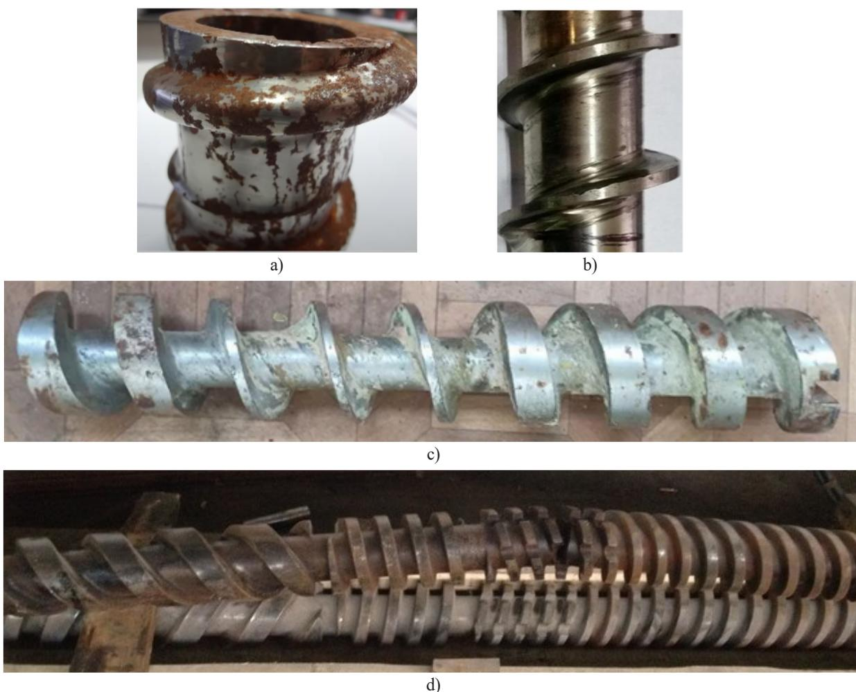
**Рис. 5. Износ и поломка шнеков экструдеров:**
