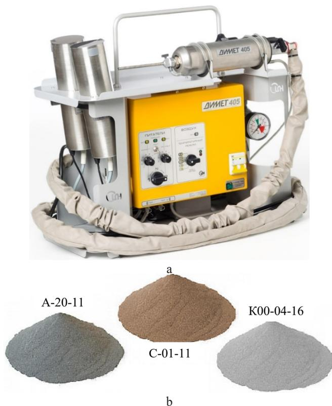
**Рис. 1. Установка Димет-405 (а) и используемые материалы (б)**
