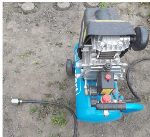
Рис. 2. Газоструйный излучатель, соединенный с компрессором Wert
