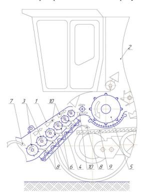
Рис. 1. Принципиальная схема сепаратора очесанного вороха ротационного типа [13]:
