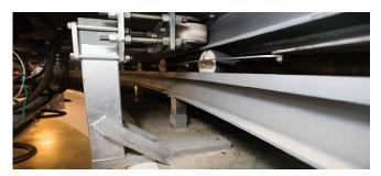
Рис. 4. Боковые направляющие и опорные колеса (вид изнутри)
