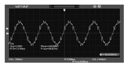
Рис. 4. Осциллограмма стационарного тока  $i_j$  фазы A батареи конденсаторов без RL-контура Fig. 4. Oscillogram of the stationary current  $i_j$  of phase A of a capacitor bank without a RL circuit
