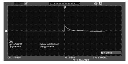
Рис. 7. Осциллограмма переходного тока  $i_1$  фазы A батареи конденсаторов при R=10 Ом Fig. 7. Oscillogram of the transient current  $i_1$  of phase A of the capacitor bank at R=10 ohms
