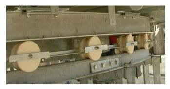
Рис. 3. Движители доильной платформы – опорные колеса с рельсами (верхний рельс подвижный, нижний – неподвижный)
