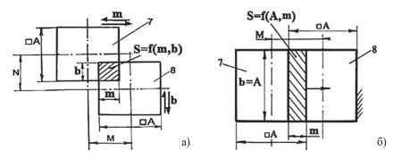
Puc. 2. Схема смещения выходного окна, образуемого корпусом (7) и заслонкой (8) смесителя Fig. 2. Scheme of the displacement of the exit port formed by the housing (7) and the valve (8) of the mixer
