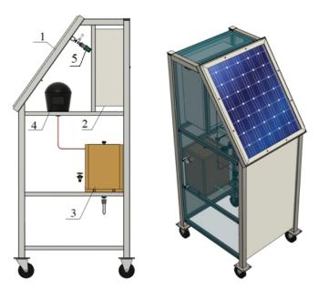
Рис. 1. Компоновка экспериментального стенда теплового насоса:
