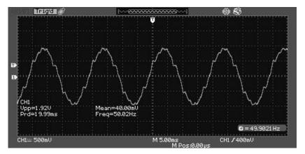
Puc. 5. Осциллограмма стационарного тока  $i_I$  с RL-контуром при R=20 Om Fig. 5. Oscillogram of stationary current  $i_I$  with an RL circuit at R=20 ohms
