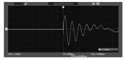
Рис. 9. Переходной ток  $i_i$  фазы A батареи конденсаторов при отсутствии резисторов Fig. 9. Transient current  $i_i$  of phase A of the capacitor bank without any resistors
