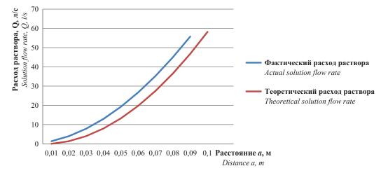
Puc. 6. Зависимости расхода Q от расстояния a при последовательном изменении переменных величин Fig. 6. Relationship between the flow rate Q and the distance a with consecutive changes in variables
