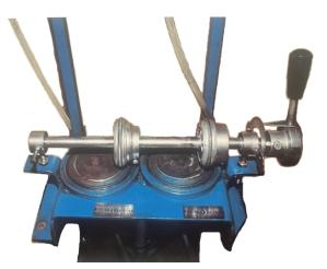
Puc. 5. Механизм дозирующего устройства смесителя Fig. 5. Dosing mechanism of the mixer
