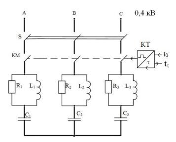
Рис. 1. Принципиальная электрическая схема батареи конденсаторов ( $\mathrm{C_1},\mathrm{C_2},\mathrm{C_3}$ ), управляемой реле времени (KT) и защищаемой от пусковых токов тремя RL-контурами
