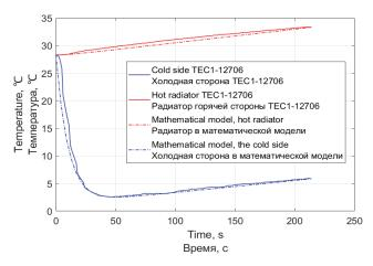
Рис. 5. Сравнение математической модели с реальной системой
