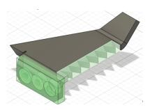
Рис. 3. Модель почвообрабатывающей пластины с исключенными зонами расчета
