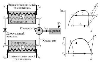
Рис. 2. Схема и цикл парокомпрессионного теплового насоса:
