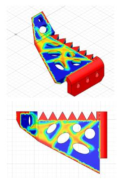
Рис. 6. Модель почвообрабатывающей пластины после второй итерации
