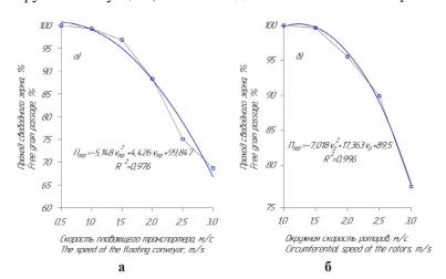
**Рис. 5.** Зависимость прохода зерна от скорости подачи вороха: а) решетчатое днище наклонной камеры; б) роторный сепаратор
