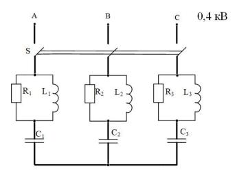
Рис. 3. Принципиальная схема физической модели на базе трехфазной батареи конденсаторов
