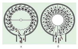
Рис. 1. Технологические схемы доильного зала «Карусель» с расположением оператора внутри платформы типа «Елочка» (а) и снаружи типа «Параллель» (б)
