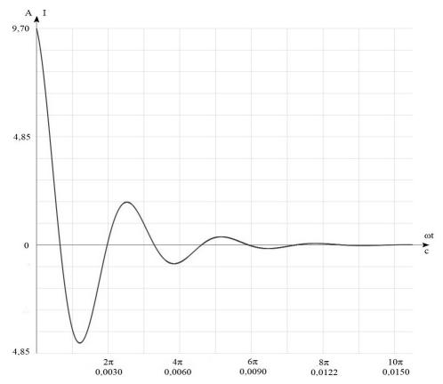
Рис. 8. Переходной ток  $i_1$  фазы A батареи конденсаторов при R = 30 Om Fig. 8. Transient current  $i_1$  of phase A of the capacitor bank at R = 30 ohms
