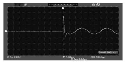
Puc. 6. Осциллограмма переходного процесса для тока  $i_t$  фазы A батареи конденсаторов при R = 20 Om Fig. 6. Oscillogram of the transient process for the current  $i_t$  of phase A of the capacitor bank at R = 20 ohms
