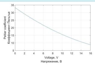
Рис. 4. Регрессионная модель изменения коэффициента Пельтье TEC1-12706
