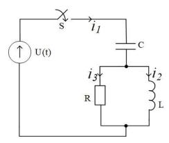
Рис. 2. Принципиальная электрическая схема математической модели фазы батареи конденсаторов
