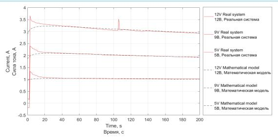
Puc. 3. Сравнение изменения сопротивления TEC1-12706 математической модели с реальной системой Fig. 3. Comparison of the resistance variation of the TEC1-12706 mathematical model with a real system
