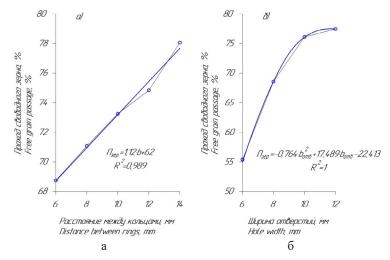
Рис. 4. Зависимость прохода зерна от расстояния между кольцами ротора (a) и ширины отверстий решетчатого днища наклонной камеры (б)
