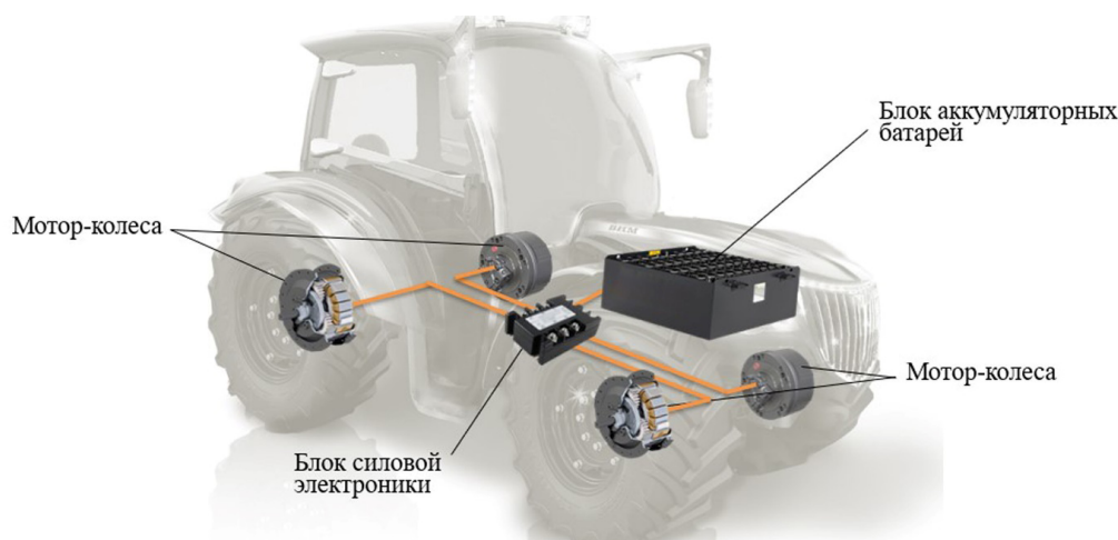
Рис. 6. Схема энергосредства на аккумуляторных батареях с электрической трансмиссией
