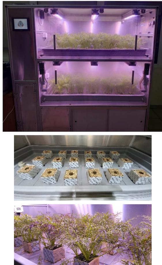
Рис. 1. Двухъярусный гидропонный модуль (производство ВИМ)
