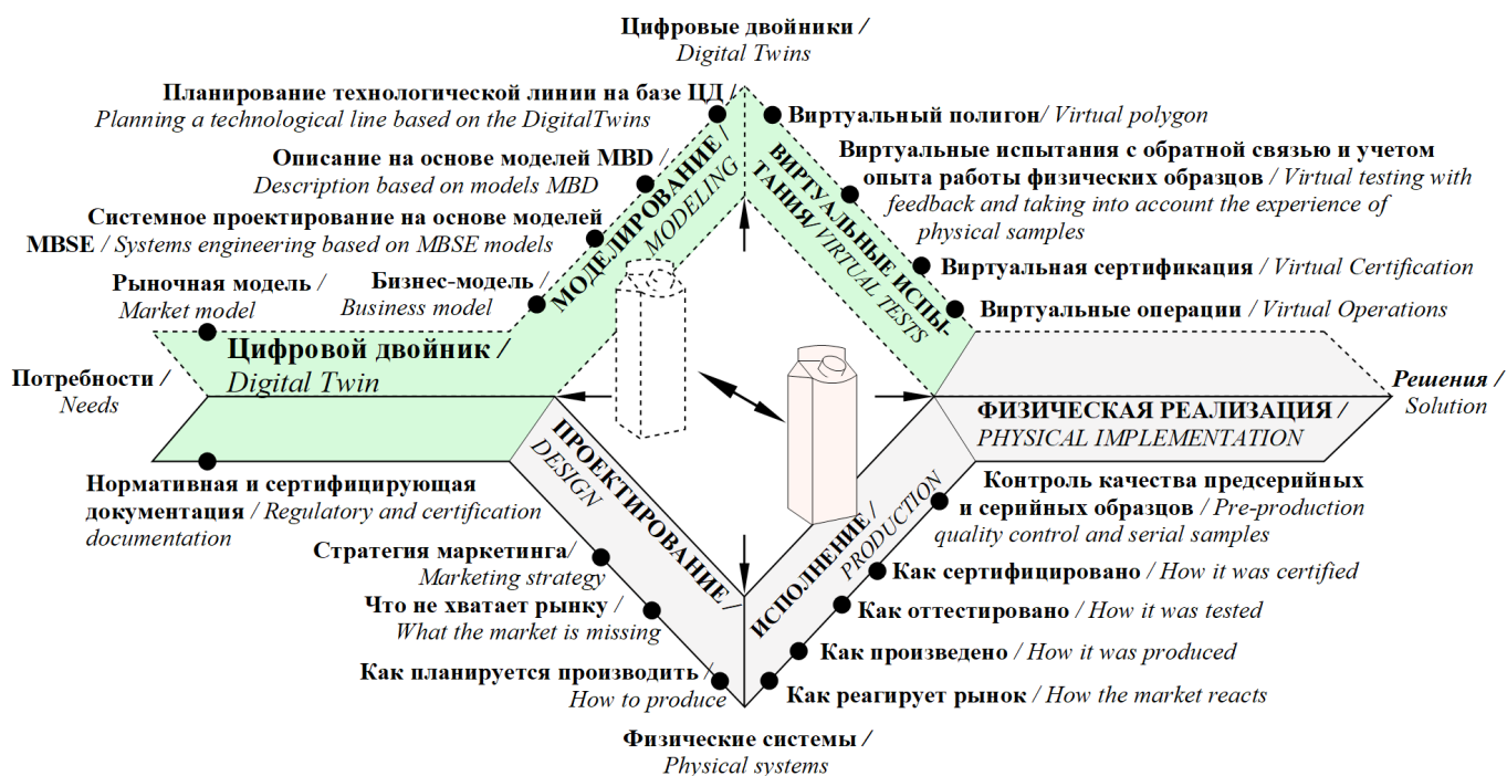
Рис. 3. Концепция цифровых двойников при разработке сельскохозяйственных машин, объектов, процессов Fig. 3. Concept of the digital twins used for designing agricultural machines, objects, processes, including all modern available technologies
