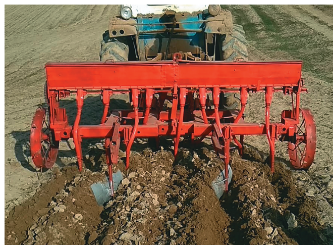
Рис. 5. Комбинированное орудие для обработки почвы и посева, работающее на склоновом поле
