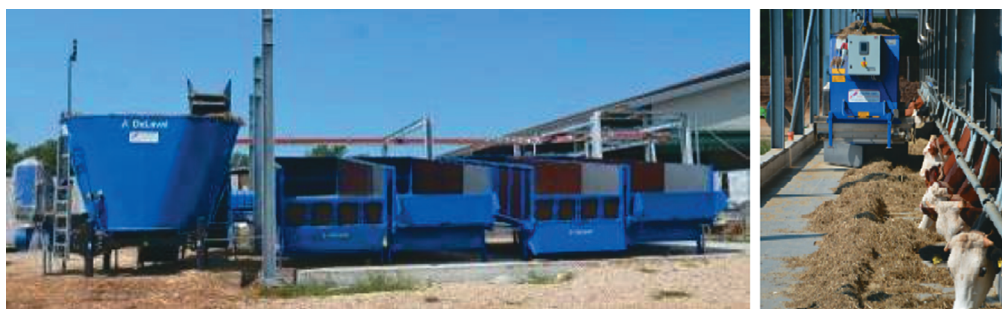
Рис. 2. Состав автоматической системы кормления DeLaval Optimat Master : кормовая кухня (слева) и подвесной робот-кормораздатчик (справа) [28]
