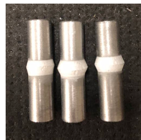
Рис. 2. Заготовка образцов после напыления
