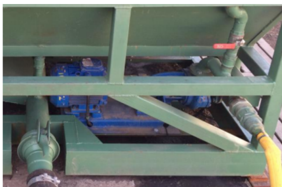
Рис. 4. Погружной насос и подключение подачи и слива Fig. 4. Submersible pump and its supply and drain cross-connection
