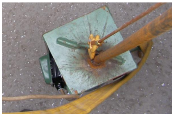
Рис. 4. Погружной насос и подключение подачи и слива Fig. 4. Submersible pump and its supply and drain cross-connection
