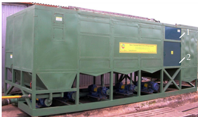
Рис. 3. Станция очистки навозных стоков: 1 – электроозонирующий блок; 2 – камера обработки навоза
