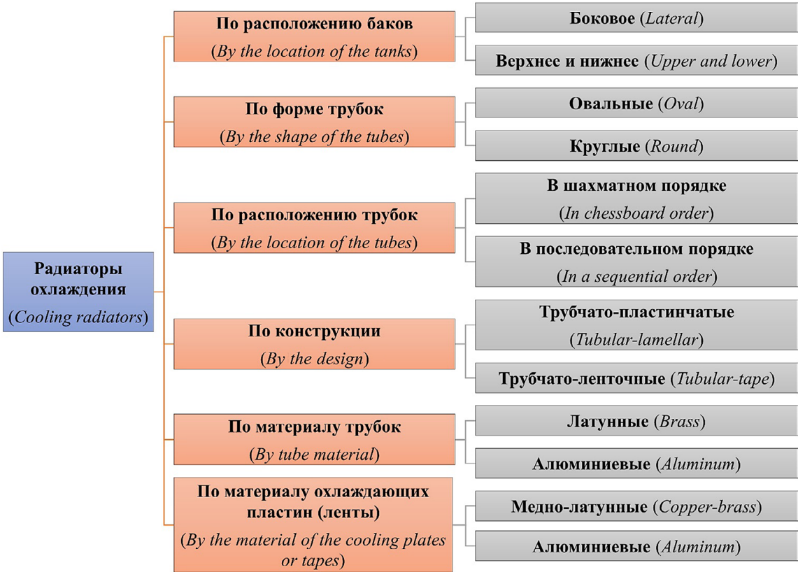
Рис. 3. Классификация радиаторов системы охлаждения ДВС Fig. 3. Classification of radiators of the cooling system of internal combustion engines
