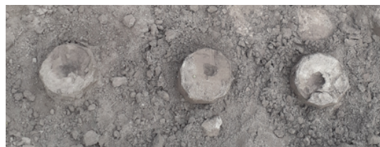
Рис. 5. Деформация почвенных образцов при сбросе давления ресивера Fig. 5. Deformation of soil samples when the receiver pressure is released
