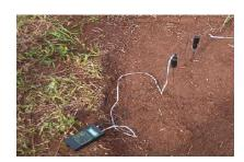
Рис. 2. Измеритель влажности почвы TP 46908 Fig. 2. Soil moisture meter
