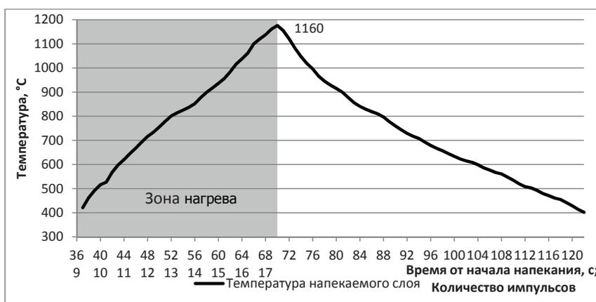
Рис. 3. Режим нагрева и охлаждения во время напекания порошка ПР-Н80Х13С2Р на втулку
