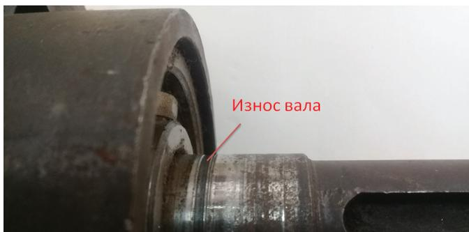
Рис. 4. Износ вала
