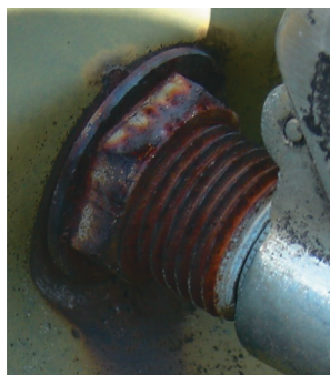
Рис. 1. Внешний вид резьбовых соединений сельскохозяйственной техники при эксплуатации и длительном хранении
