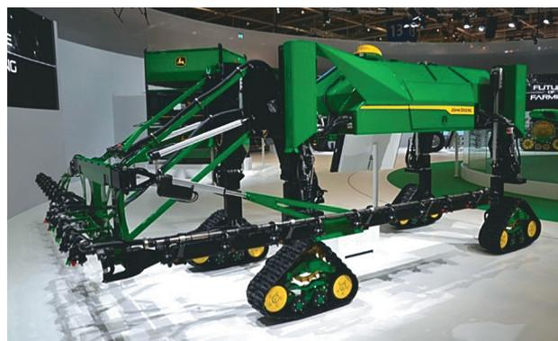
**Рис. 3. Автономный опрыскиватель JohnDeere**
