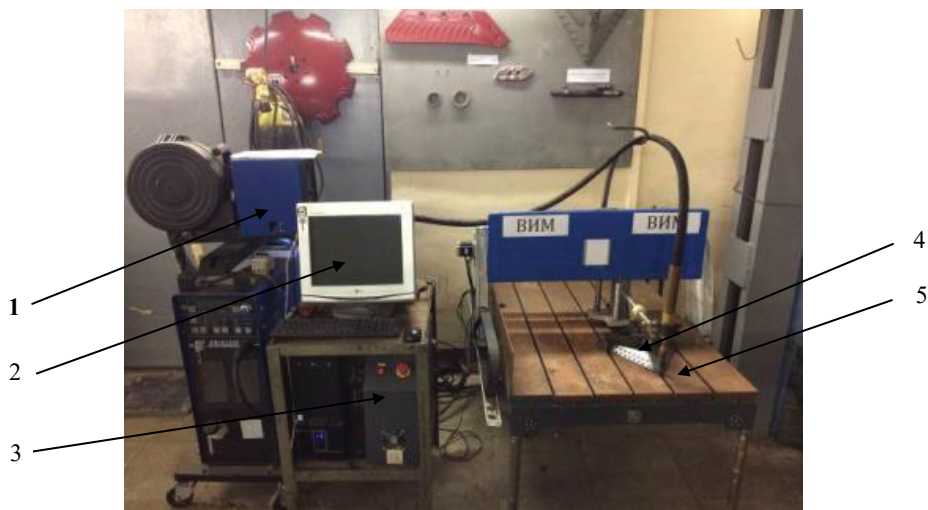
Рис. 3. Автоматизированная установка для наплавки рабочих органов: 1 – сварочный полуавтомат; 2 – компьютер; 3 – блок управления; 4 – рабочий орган; 5 – станок с программным управлением
