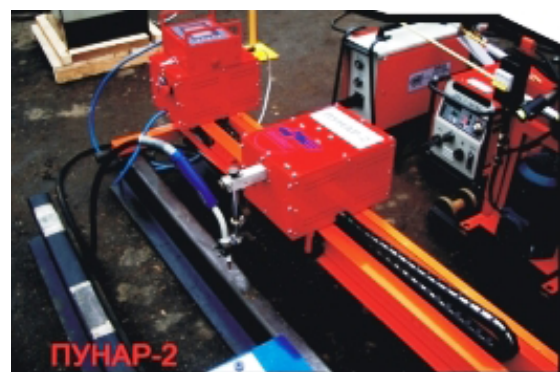
Рис. 2. Автоматическая установка для наплавки рельсов
