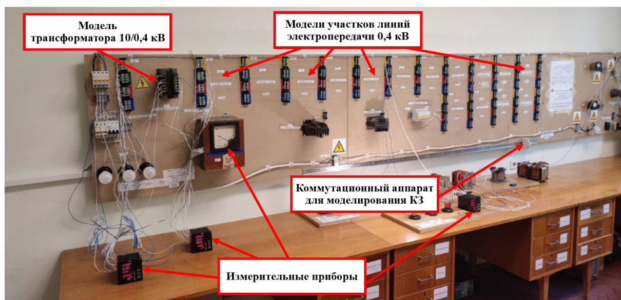
Рис. 2. Внешний вид физической модели сельской электрической сети 10/0,4 кВ [19]
